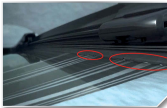
Cracked blade Poröses Wischgummi
