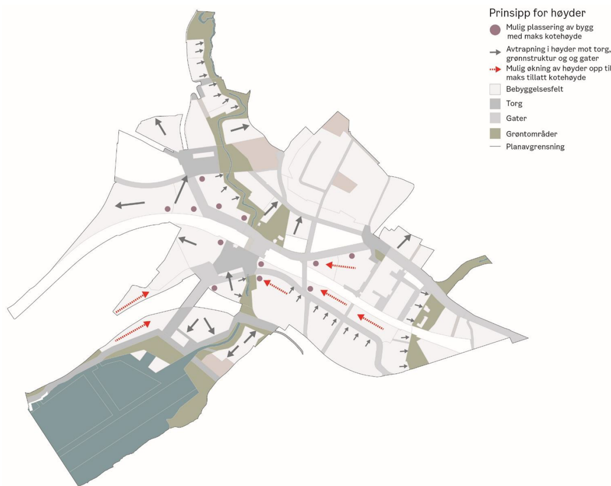
12.2 Prinsipper for høyder på planlagt bebyggelse
