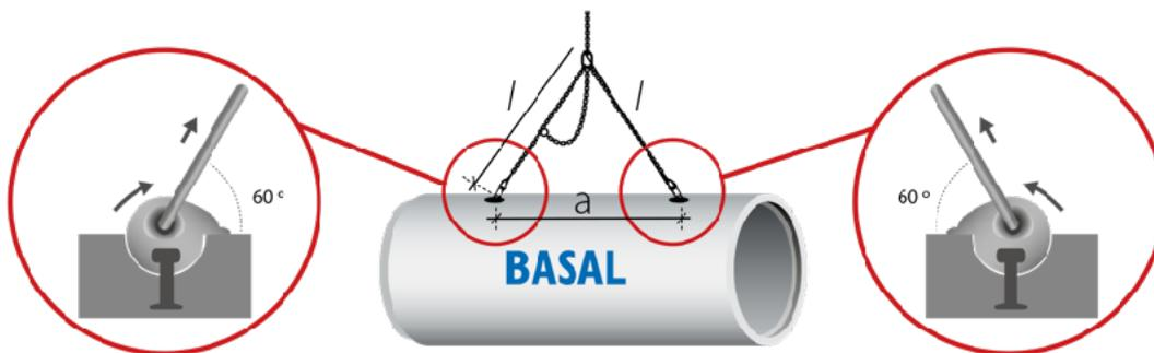
Kjettingskretvet's toppvinkel må ikke være større enn  $60^\circ$ . Dette oppnås ved at kjettingene i kjettingskretvet er like lange eller lengre enn avstanden mellom løfteankerene ( $l > a$ ).
