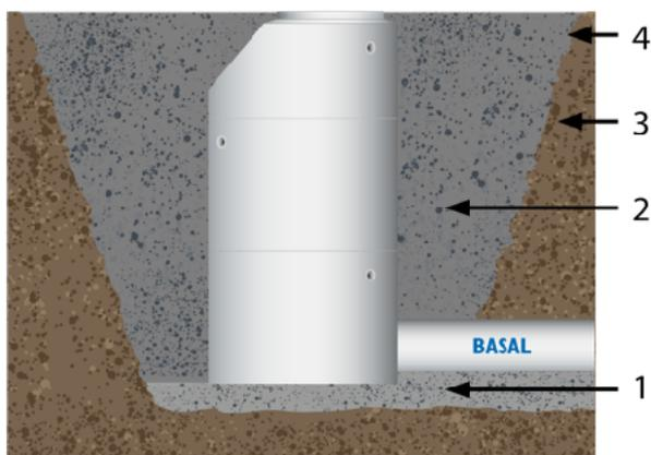
1. **Fundament.** Samme massetyper og kornfraksjon som for rør.
