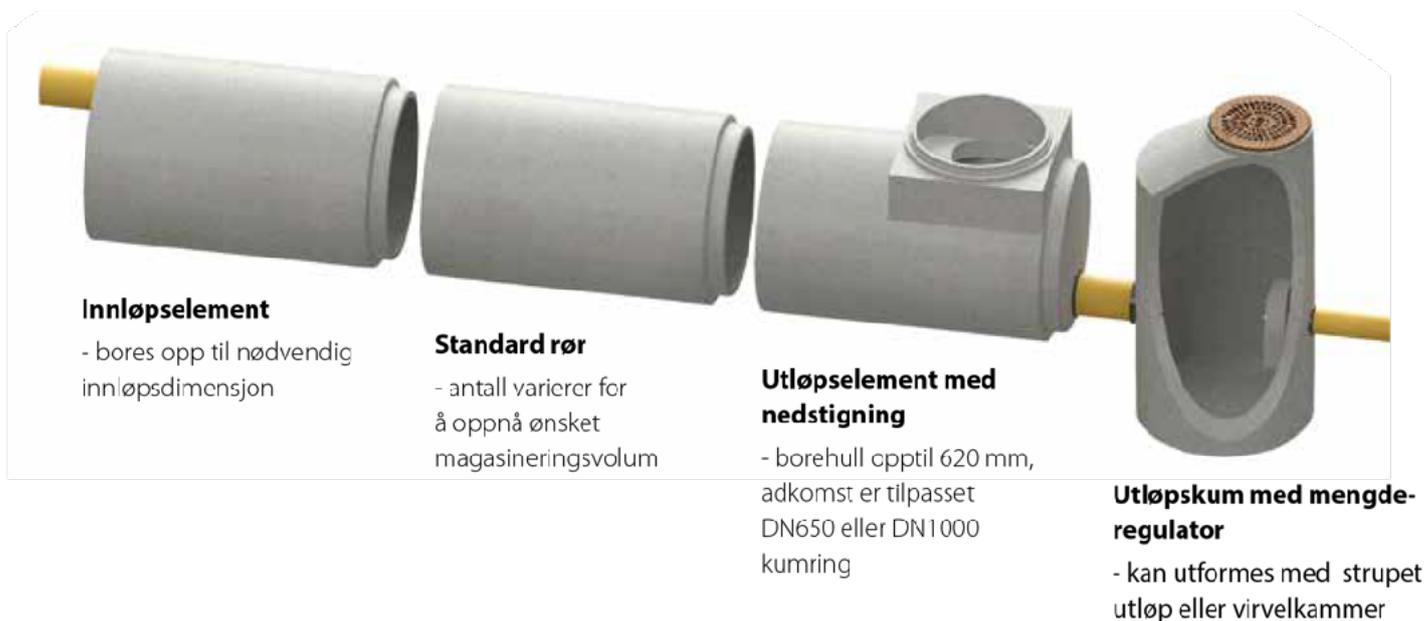
Overvannsløsninger fra Basal er fleksible i forhold til oppbygging. Det fungerer nærmest som et byggkloss system og kan enkelt settes sammen til ulike varianter, avhengig av hva man ønsker å oppnå. Rørmagasiner leveres normalt i DN 1000-2400.
