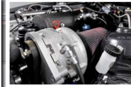
PRESSE. ESS har fått Vortec til å lage en kompressor etter sine spesifikasjoner.
