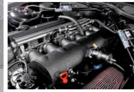
STEG FOR STEG. Det store plenumkammeret tvinget seg frem allerede ved 450 hk, da originalen sprakk.
