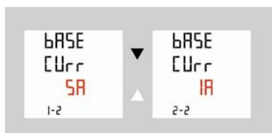
1A (ekstern strømtransformator med sekundær /1A) eller 5A (ekstern strømtransformator med sekundær /5A)
