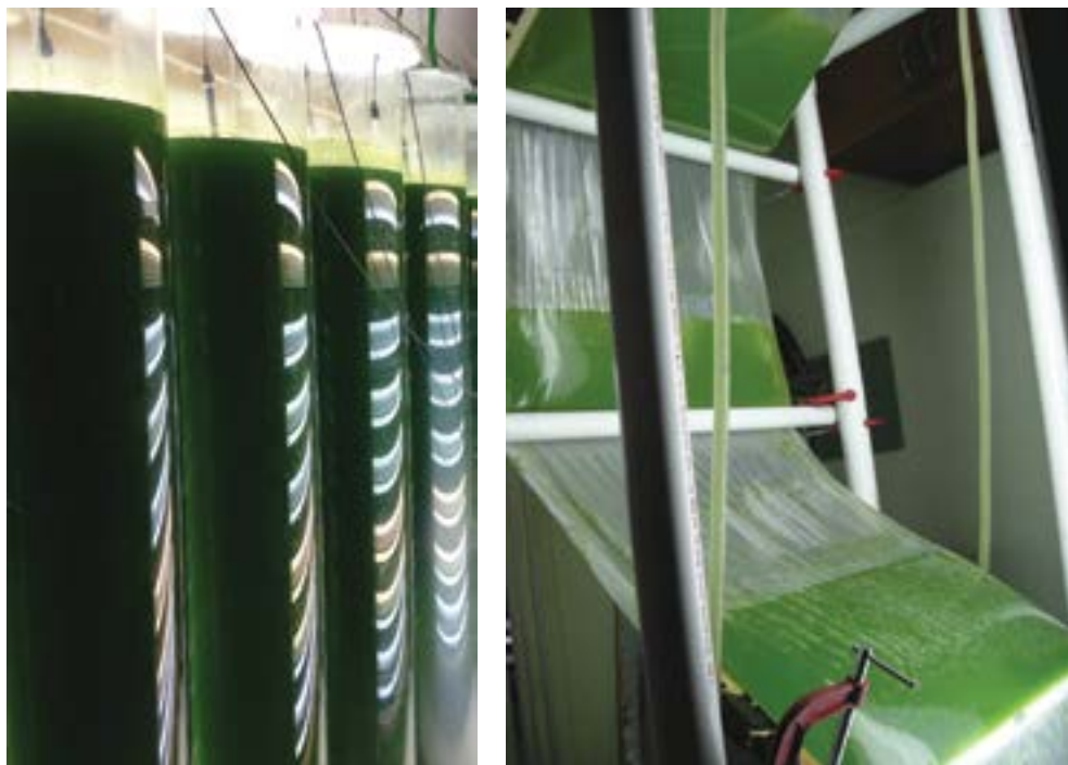
Figur 1. To algereaktorer som har blitt benyttet til forskning på algevekst ved Universitetet i Agder.
