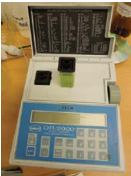
Figur 3. Spektrofotometer benyttet til absorbansemåling av algeløsninger.
