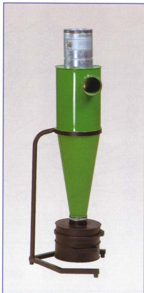
En anden og meget sikker måde at opsamle slibestøvet på er at tilkoble en cyklon til udsugningen. I en cyklon, hvor der er en uhindret gennemstrømning, separeres slibestøv og luft. Slibestøvet lægges i en støvbeholder, medens den rene luft ledes ud i det fri i toppen af cyklonen. Undervejs passerer luften et mikrofilter, der fjerner de evt. resterende meget fine støvpartikler.
