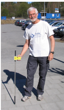
CB DiffAnt kabelsøker med to antenner.
