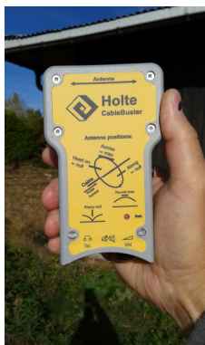
CableBuster kabelsøker med én antenne.
