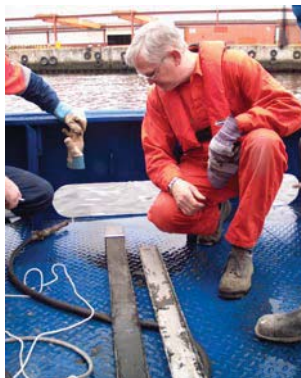
GeoSubSea har utviklet og bygget en kjerneprøvetaker med firkantprofil. Den ene siden av kjernerøret er et lokk som kan tas av. Derved får en direkte tilgang til kjerneprøven for bl.a. strukturbeskrivelse og geotekniske målinger uten å forstyrre prøven med utstøting eller oppsaging. Prøvetakeren finnes i dimensjon 8 x 8 cm og 20 x 20 cm tverrsnitt på kjernerør. Den kan benyttes både som vibrocorer (8x8 cm, - bildene over) og pælecorer (20 x 20 cm og kjernerør inntil 8 meters lengde, - bildet til høyre) og gravitycorer (8 x 8 cm og 20 x 20 cm)
