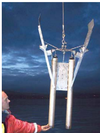
Twincorer er en liten variant av Multicorer som er spesielt egnet for kystfarvann og vassdrag. Den tar to uforstyrrede kjerneprøver av bunnens øverste ca. 25-40 cm.
