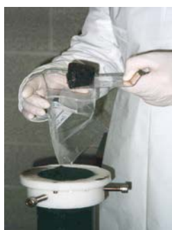
Uttak av analyseprøver til kjemiske analyser. Fare for innblanding av miljøgifter fra forurensede til "rene" lag under preanalysebehandlingen av prøvene er svært stor. GeoSubSea's kvalitetssystem har dokumenterte prosedyrer for å forhindre slik kontaminering.
