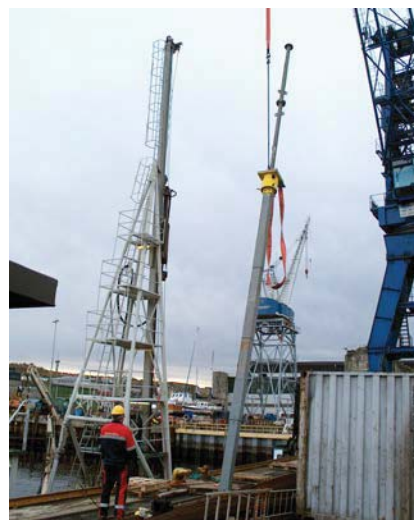
GeoSubSea har utviklet og bygget en kjerneprøvetaker med firkantprofil. Den ene siden av kjernerøret er et lokk som kan tas av. Derved får en direkte tilgang til kjerneprøven for bl.a. strukturbeskrivelse og geotekniske målinger uten å forstyrre prøven med utstøting eller oppsaging. Prøvetakeren finnes i dimensjon 8 x 8 cm og 20 x 20 cm tverrsnitt på kjernerør. Den kan benyttes både som vibrocorer (8x8 cm, - bildene over) og pælecorer (20 x 20 cm og kjernerør inntil 8 meters lengde, - bildet til høyre) og gravitycorer (8 x 8 cm og 20 x 20 cm)
