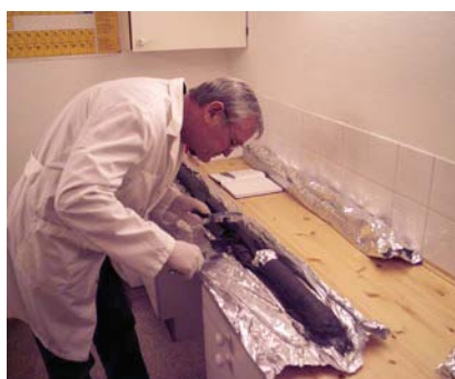
Sedimentbeskrivelse (kjerne logging) med uttak og preanalysebehandling av prøvemateriale utføres av geolog i GeoSubSea's laboratorium i Trondheim. GeoSubSea formidler organiske-/uorganiske kjemiske og sedimentologiske analysetjenester til akkrediterte laboratorier.
