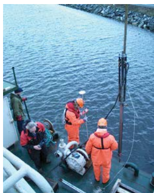
GeoSubSea har utviklet og bygget en kjerneprøvetaker med firkantprofil. Den ene siden av kjernerøret er et lokk som kan tas av. Derved får en direkte tilgang til kjerneprøven for bl.a. strukturbeskrivelse og geotekniske målinger uten å forstyrre prøven med utstøting eller oppsaging. Prøvetakeren finnes i dimensjon 8 x 8 cm og 20 x 20 cm tverrsnitt på kjernerør. Den kan benyttes både som vibrocorer (8x8 cm, - bildene over) og pælecorer (20 x 20 cm og kjernerør inntil 8 meters lengde, - bildet til høyre) og gravitycorer (8 x 8 cm og 20 x 20 cm)
