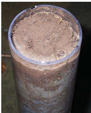
Uforstyrret kjerneprøve fra Twincorer. Prøven er særlig egnet for miljøundersøkelse av de øverste cm av sjøbunnsedimentene i forbindelse med trend-overvåking.
