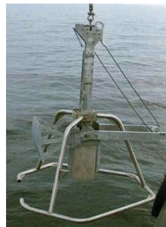
Box-corer tar store prøver (30 x 30 cm) av sjøbunnens øverste 30 – 50 cm. Slike prøver benyttes til geotekniske, geokjemiske og marinbiologiske undersøkelser.
